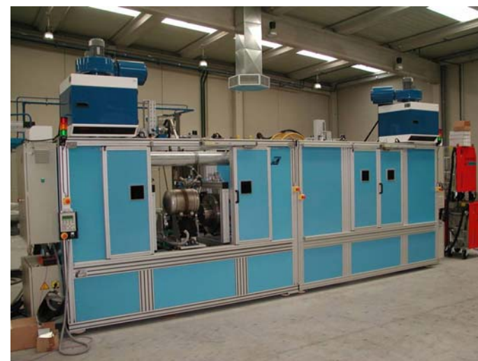
Soldadura Mig Pulsado – 3 arcos de soldadura simultáneos (cierre botella, asa y base de la botella)
