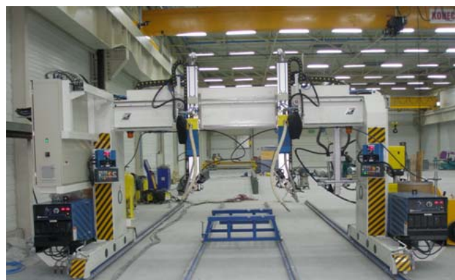
PORTICO SOLDADURA S.A.W.
