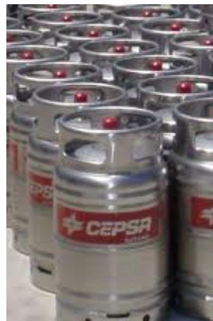
Soldadura Mig Pulsado – 3 arcos de soldadura simultáneos (cierre botella, asa y base de la botella)
