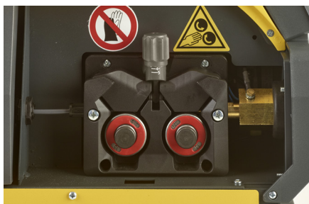
Mecanismo de alimentación profesional de doble ranura con 4 rodillos
